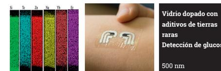
El erbio es un elemento de tierras raras que tiene propiedades específicas de absorción de luz. Cuando el erbio absorbe la luz de longitudes de onda particulares, irradia luz en longitudes de onda útiles. Esta longitud de onda puede ser controlada con precisión para detectar moléculas de glucosa, incluso a través de la piel y de los vasos sanguíneos, lo que permite la detección no invasiva de glucosa en pacientes con diabetes.
