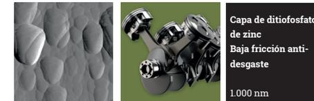
Los revestimientos y los aditivos para lubricantes ayudan a reducir la fricción y el desgaste de los componentes del motor. El dialquil-ditiofosfato de zinc (ZDDP) forma una capa blanda y deformable en las superficies móviles del motor de un coche (pistón o árbol de levas) que permite que las partes que se deslizan una sobre otra lo hagan con mayor facilidad.
