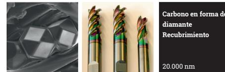
El carbono en forma de diamante se utiliza en ingeniería como recubrimiento duro en componentes metálicos para reducir el desgaste. Existen diferentes formas que se pueden combinar para dar propiedades específicas a un recubrimiento.
