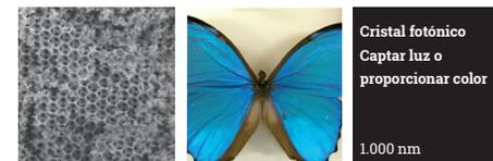
La estructura porosa y regular a nanoescala de los cristales fotónicos se puede utilizar para captar luz o para proporcionar color (como en las alas de una mariposa). La estructura regular del orificio actúa como una red de difracción - ciertas longitudes de onda de la luz se captan y se absorben. La luz restante da lugar a distintos colores.
